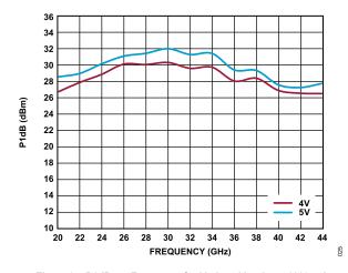
Figure 25. P1dB vs. Frequency for Various  $V_{\rm DD}$ ,  $I_{\rm DQ}$  = 1200 mA
